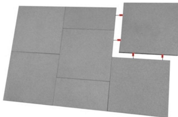
Die Verlegung der Fallschutzplatten kann in Kreuzfuge oder auch im Halbverband (Versatz) erfolgen. Bei Verlegung werden die Platten untereinander mit Systemsteckern gesichert. Dabei ist darauf zu achten, dass die Platten so eng wie möglich aneinander gelegt werden. Besonders wichtig für ein lagesicheres Oberflächenbild ist die Anordnung einer festen Randeinfassung.
