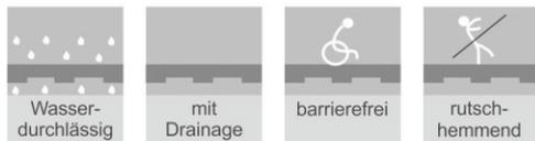
Verlegung auf sickerfähigen Untergründen wie z.B. Lava, Basalt, Schotter, Splitt, etc. und auf ebenen, festen Untergründen möglich.
