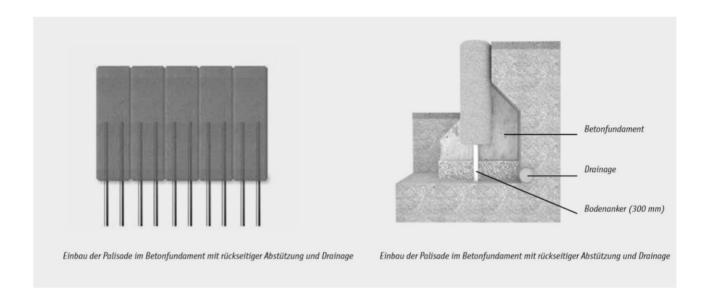
In Rechteck-Palisaden sind grundsätzlich zwei Bodenanker (300mm) eingelassen mit denen die Rechteck-Palisade in einem Betonfundament aus erdfeuchtem Magerbeton (C 12/15) verankert wird. Dadurch wird eine sehr hohe Stabilität als Einfassung oder Hangabsicherung bei gleichzeitig flexibler Gestaltungsmöglichkeit erreicht.
