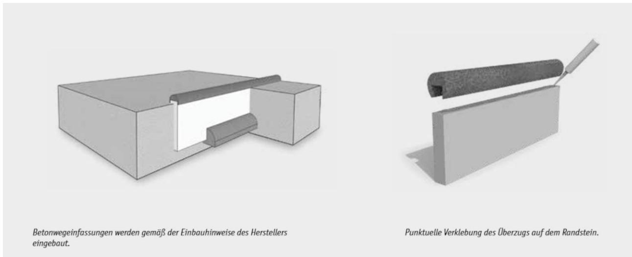
Betoneinfassungen werden gemäß der Einbauhinweise des Herstellers eingebaut. Die Gummikappe wird mit dem Kartuschenkleber auf die Betoneinfassung aufgeklebt.
