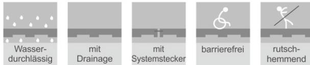
Verlegung auf ebenen, festen oder wasserdurchlässigen Untergründen. Generell sind die Platten im Halbverband mittels Systemstecker zu verlegen.
